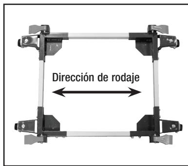
Una base estrecha y corta tal como se encuentra en una prensa taladradora o sierra de banda puede ser un beneficio para esta disposición. Debido a la rotación giratoria, la base puede asentarse fuera de nivel. Gire la rueda giratoria alejada de la base para corregir el nivel.
