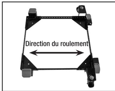
Une courte base étroite, comme celle qu'on trouve sur une perceuse ou une scie à ruban, pourrait bénéficier de cet arrangement. En raison de la rotation pivotante, la base pourrait se trouver hors de niveau. Tournez la roue pivotante en l'éloignant de la base pour corriger.
