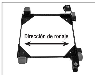
Una base estrecha y corta tal como se encuentra en una prensa taladradora o sierra de banda puede ser un beneficio para esta disposición. Debido a la rotación giratoria, la base puede asentarse fuera de nivel. Gire la rueda giratoria alejada de la base para corregir el nivel.
